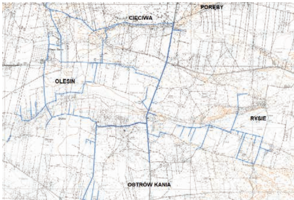
ETAP I - Zaprojektowana i częściowo wykonana sieć wodociągowa.
