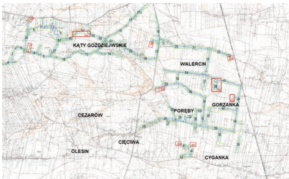
ETAP II - Zaprojektowana i częściowo wykonana sieć wodociągowa dalsza realizacja planowana w latach 2019-2021.
